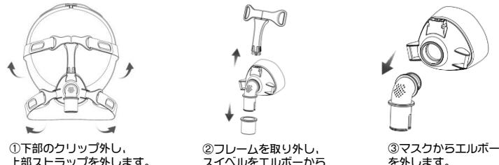
①下部のクリップ外し、上部ストラップを外します。
